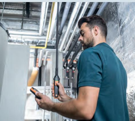
Tiene tantas posibilidades como mediciones te encuentras en tu trabajo: con el instrumento de medición multifunción testo 440 podrá medir todos los parámetros relevantes para la calidad del aire interior de forma rápida, intuitiva y muy cómoda. Gracias a una amplia gama de sondas y una gran selección de accesorios, tendrás bajo control todas las mediciones relativas a los sistemas de aire acondicionado y ventilación: en conductos, salidas y filtros.
